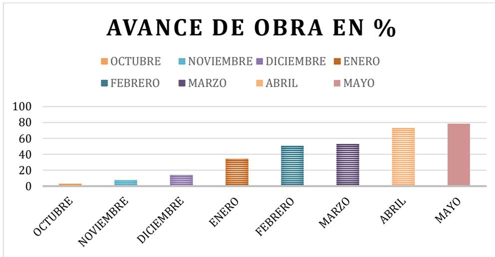
Al mes de mayo se evidencia un incremento de avance debido a que esta pronta la finalización, los módulos están en proceso de instalación de puertas y ventanas, algunos están finalizando el proceso de mampostería, falta culminar exteriores y circulaciones.
